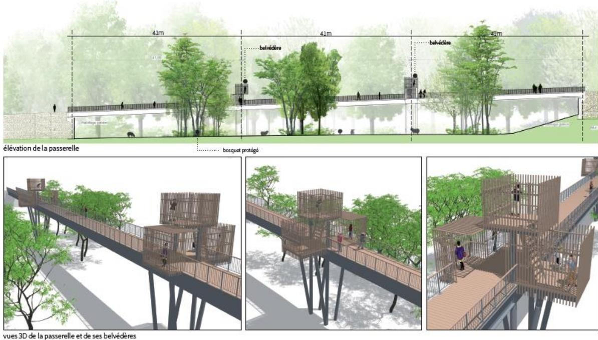
Figure 33 : Plan et vues 3D de la passerelle - source: ILEX
