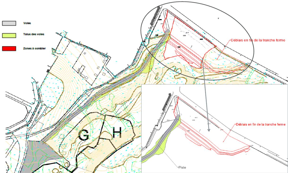
Figure 14 : Terrassements des pistes et remblaiement - piste A
