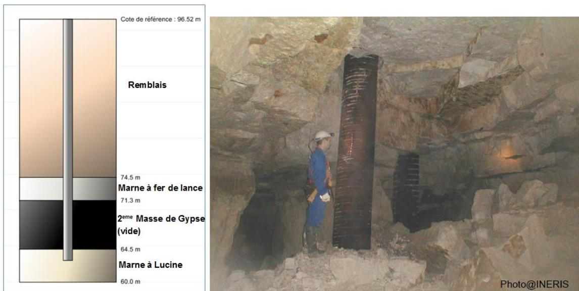
Figure 18 : Exemple de profil de pieu au niveau de l'appui N°3 et photographie de pieux traversant - source :EGIS
